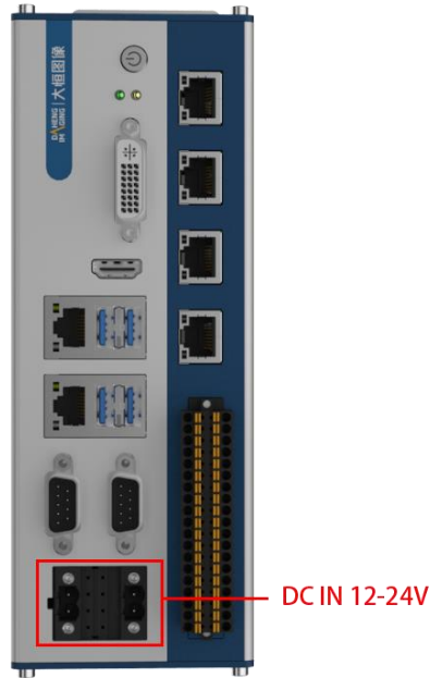
图 2-5 PALLAS BOX 系列电源接口位置图
