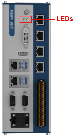
图 2-3 PALLAS BOX 系列 LED 灯位置图
