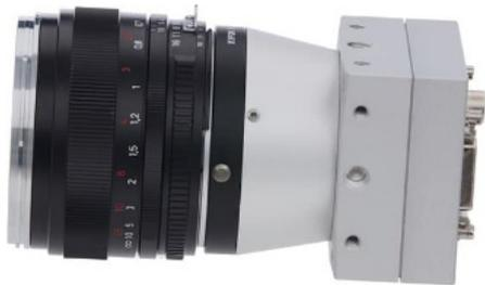
CamPerform CL 系列相机通过 CamareLink 数据接口进行数据传输，在全分辨率下帧率可达 500fps，采用 130 万像素 OnSemi LUPA1300 大靶面传感器。CamPerform CL 系列 CL600x2 M/C 相机具有许多卓越的特性使得相机能够灵活应用于不同的测量应用中，在增加传感器 X/Y 方向的图像速率上表现尤为突出，非常适用于 2D/3D 快速测量应用。
